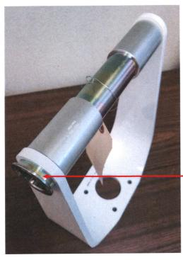
NOTE: THE AXLE TUBE IS STICKING OUT ON ONE SIDE.
